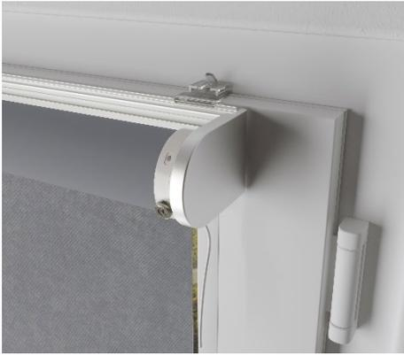
Puedes montarlo o bien en el techo o en la pared. Dibuja una pequeña marca con un lápiz en el lugar en el que quieres instalarlo, a continuación, sitúas los soportes y los atornillas al techo o a la pared y finalmente acabas encajándolo. O bien en la hoja de la ventana, únicamente encajando el estor en el borde de la ventana sin necesidad de perforar.
